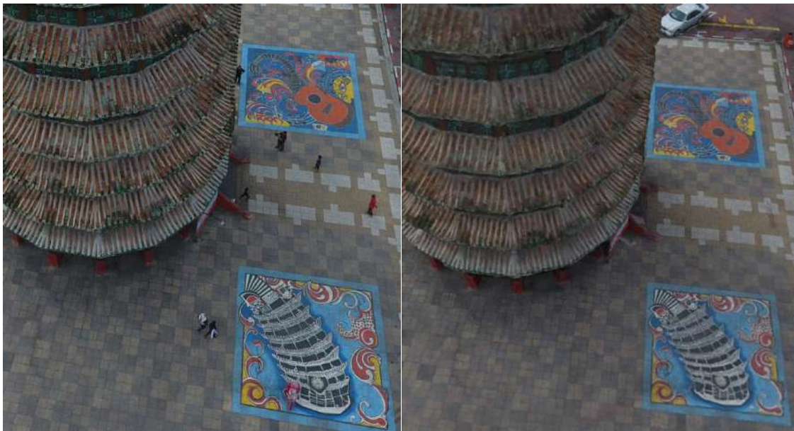
Rajah 15 : Perbandingan Imej kamera (kiri) dengan 3D Textured mesh(Kanan)
