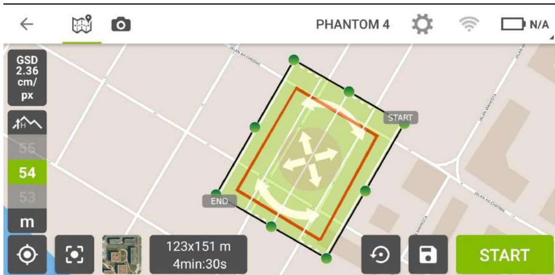
Rajah 5: Misi penerbangan UAV dengan menggunakan aplikasi Pix4Dcapture
