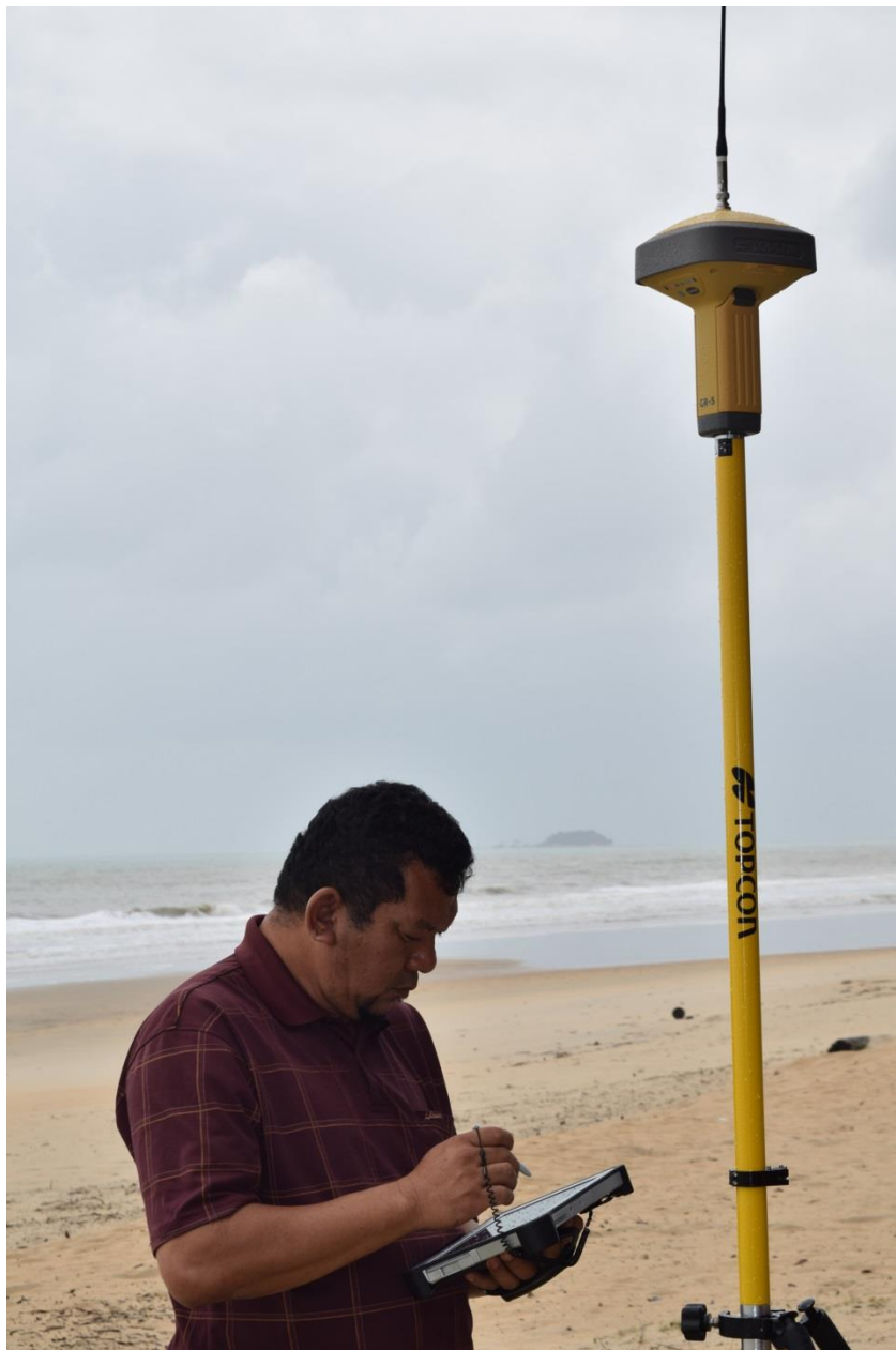
Gambar 2: Pengukur INSTUN sedang mengoperasikan modul eTSM di Data Logger / Field Communicator FZ-G1 bagi penerimaan data satelit dari GR-5
