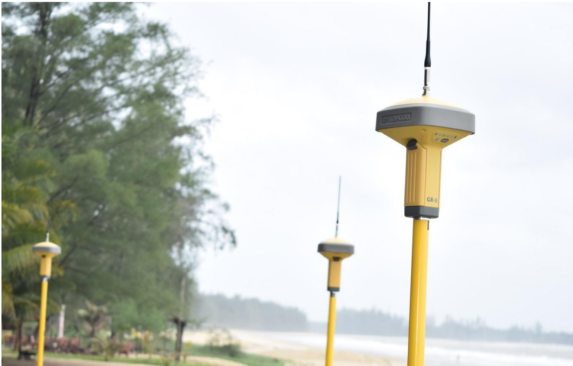
Gambar 1: Tiga unit GR-5 sedang diuji menerima data dari satelit
