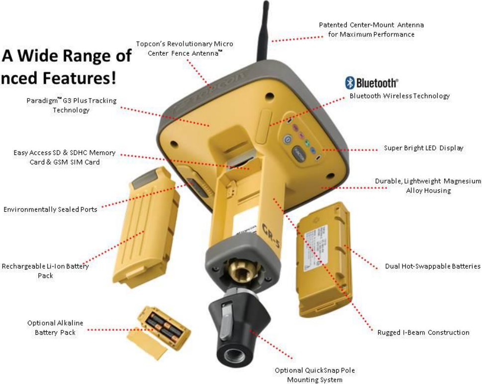
Gambar 4: Gambarajah kefungsihan setiap komponen GR-5
