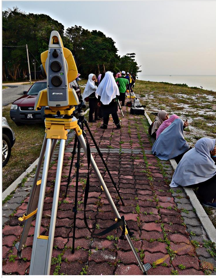
Gambar 2 : Peralatan yang digunakan adalah TopCon IS M18170
