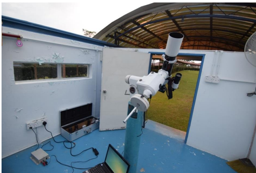
Gambar 2 : Teleskop 80mm ( Sky Watcher ) menggunakan pillar dengan mounting EQ6 yang sediaada di mini observatory.
