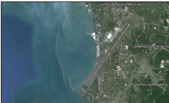
Rajah 5: Pembangunan infrastruktur kejuruteraan bagi mencegah hakisan pantai di Langkawi, Kedah (sumber: Google Earth)
